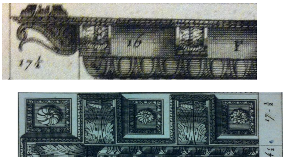
Fig. 118. Alzado y planta inferior del fragmento de la cornisa corintia de Viñola, análoga al alero rústico de Carbonel.
