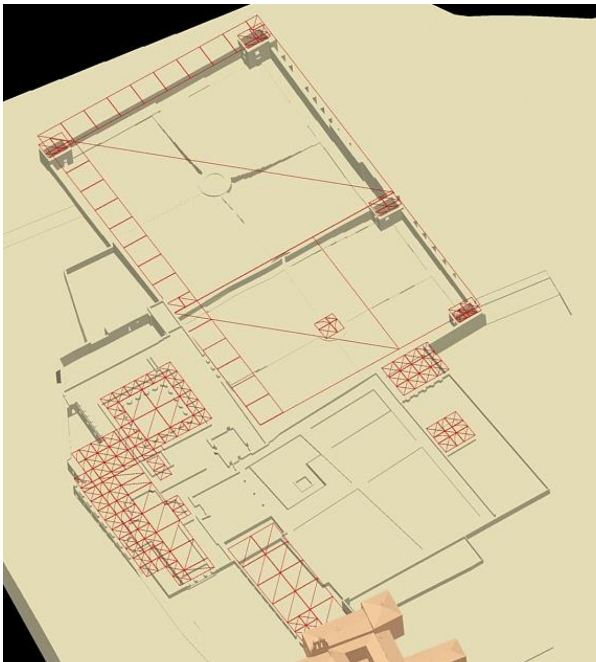
FIG. 87. Esquema del trazado regulador general del conjunto en base al módulo de 16x16pies.
