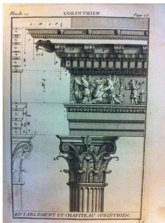
Fig.117. Columna y entablamento corintios según Viñola
